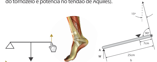
FIGURA 20 - Exemplo de alavanca inter-resistente (de segunda ordem) e respetiva representação diagramática.
