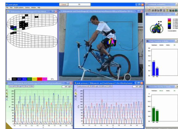
FIGURA 85 - Soluções de avaliação da pressão exercidas nos pedais e no selim em ciclismo (Pedar, Novel).
