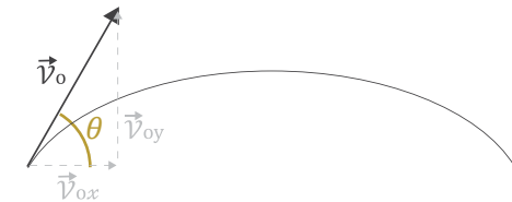
FIGURA 36 - Trajetória de um projétil lançado livremente no espaço com uma dada velocidade inicial ( v_0 ), oblíqua relativamente à horizontal.
