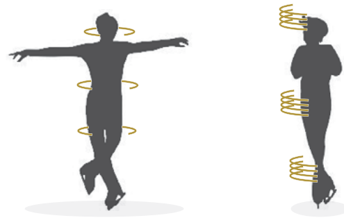
FIGURA 32 - Quando o patinador afasta parte da sua massa corporal do eixo de rotação, aumenta o seu momento de inércia, diminuindo a aceleração angular para um dado momento de força.
