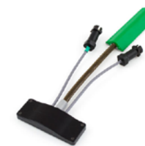
FIGURA 67 - Eletrogoniómetro de eixo duplo ( http://www.biometricsltd.com/ ).
